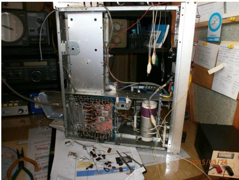
重量のかさむ電源装置を組み込む前に、入力同調回路のカット&トライ調整を行いました。コイルの巻き数、ダストコア位置、コンデンサ容量を得意の山感的変更で、最終的には各バンド SWR が 1.0 ~ 1.2 で、上々のところにうまく追い込めることができました。
