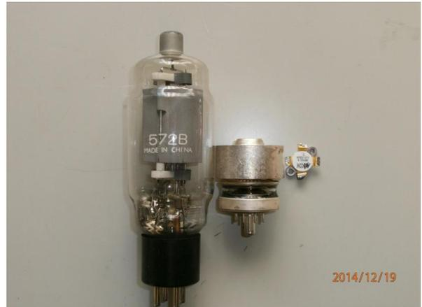
写真左の X 球と呼ばれているもので、4X150A という強制空冷で、シールドルームを作って、バンバン冷やせば、頑丈であるらしい評判を聞いていました。球の主な定格は次のようです。
