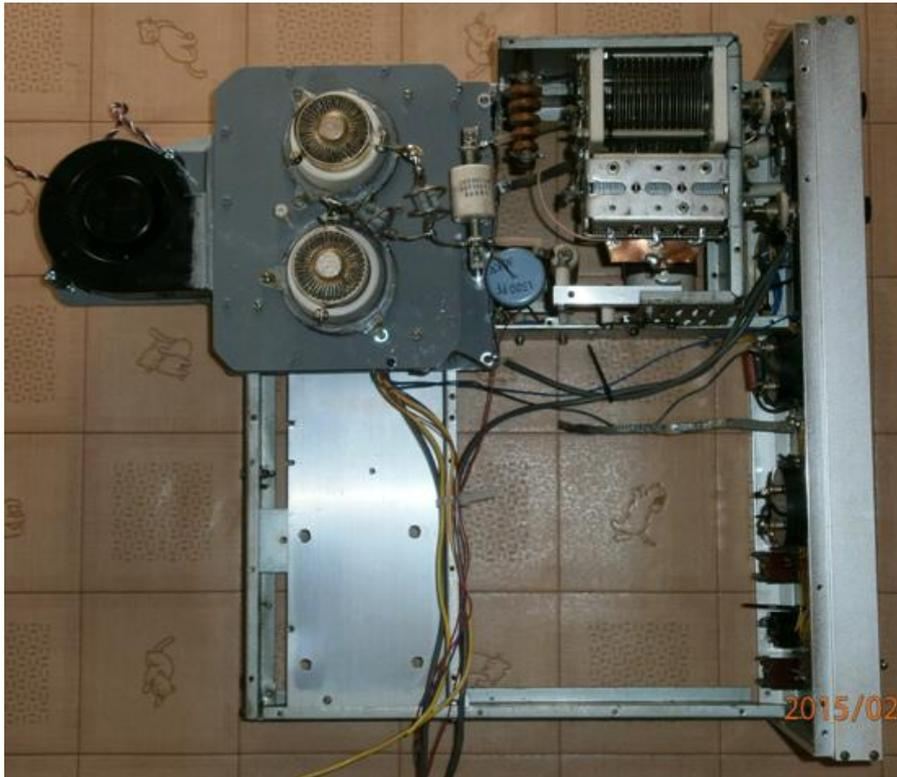
かくして上の写真のような姿で、FT401（10W トランシーバー）の器にリニヤアンプの心臓部になる X 球プッシュプル仕様の終段増幅装置を完成させることができました。下側の大きな空きスペースへ、これからぼつぼつ電源装置を組み込んでいく計画になります。
