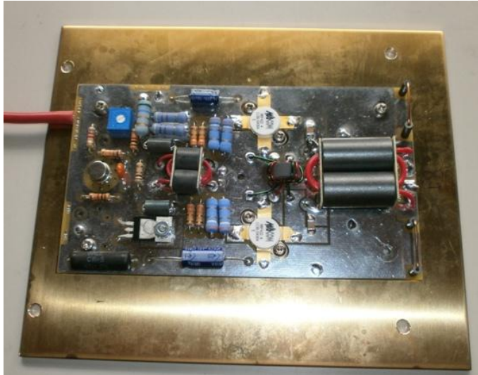
写真中程上下2個が 終段トランジスタ
