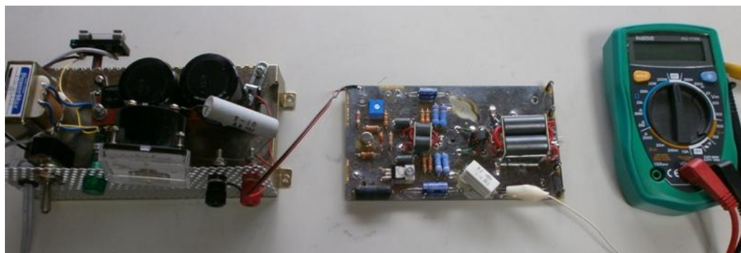
基板（写真中央、終段の石は未装着）の単独試運転（バイアス可変調節機能） 写真左は仮設電源（DC28V）
