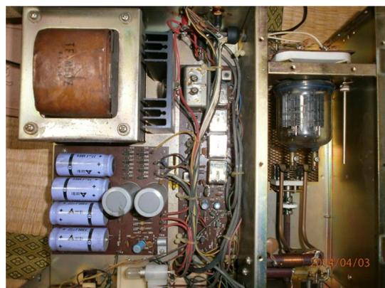
全体外観（写真左）と、写真右がケースを外し、上から覗いた様子です。（トランスの見える左側が重たい電源部、右側が真空管 AMP 部、中央部が制御部基板になっていました。）
