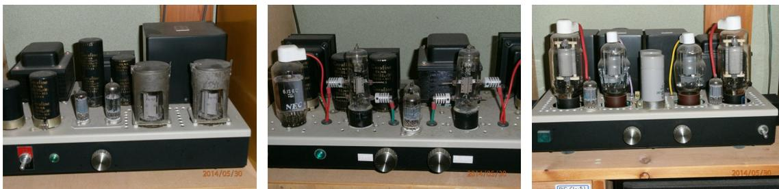
写真左のアンプは、ロシアの軍用管を利用したものです。丈夫なアルミダイキャストのカバーで保護されています。(戦闘機か艦船にでも使われていたものではないでしょうか？五極管構造です。)
