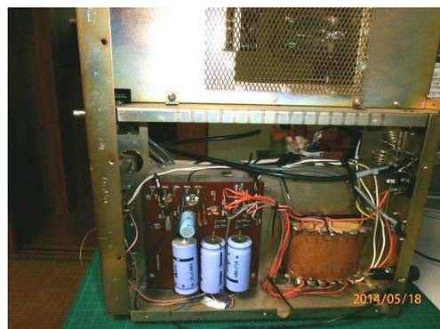
(プレート電源基板/シャーシ上面)      (グリッド電源基板/シャーシ底面)
