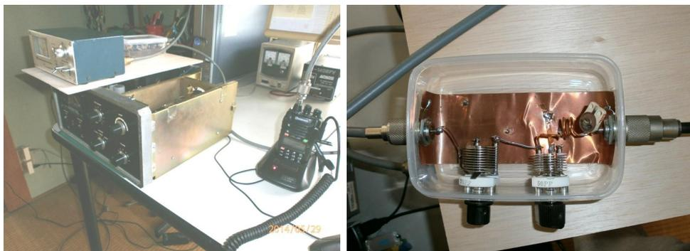
いつもの（唯一の）ハンディー機、ダミーロード、SWR/電力計、簡単なアンテナカップラーも自作しました。（写真右；UHFのカップラー自作は失敗しましたが、VHF用はOKです。）
