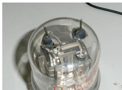
プレート（2個の角）に挿入接続するプレートキャップをネジ固定しますが、その時にプレートピンに強いモーメントがかかり、真空管のピン取り出し部が破損しかかって、真空管でなく空気管になっていたようです。
