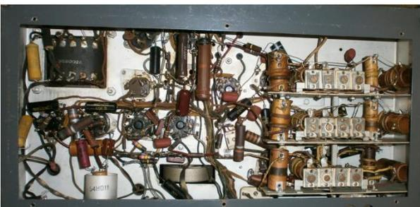
整流管のみが ST 管で、他はすべて GT 管が使用されたシングルスーパーヘテロダインです。（日本では戦後になってようやく製作されたスーパーヘテロダイン受信機が米国では古い時代にすでに実用化されていたようです。）
