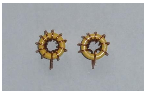
交換用に巻いたコイル
