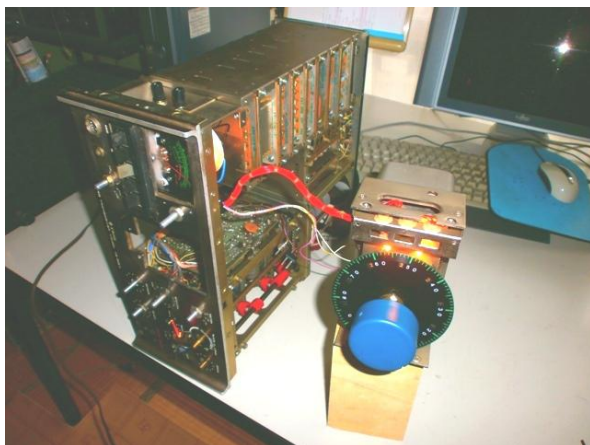
結線・通電し、正常な動作（送受信）確認中
